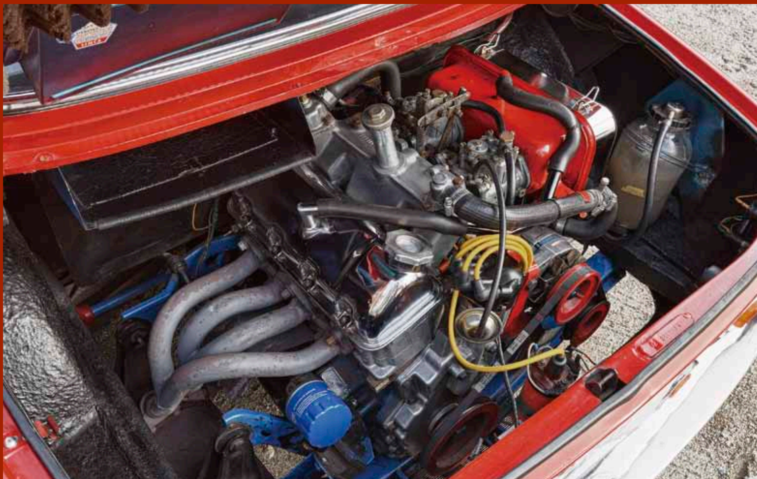
広々としたエンジンルーム内に縦置きされた1.2リッター4気筒エンジン。鉄製シリンダーとアルミOHVヘッドというイタリア車によくある組み合わせだが、10.25という高圧縮比を誇るチューンド・ユニットだ。
