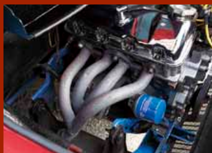
オリジナルのものより径が太く、独立部分が長いエグゾーストパイプ。タコ足直下のマフラーはイタリアのアンサカアバルトの仕事を思わせる。右下は純正のアンダーガードである。
