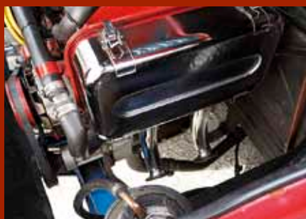
ツインチョークのソレックス2基にエアを導くエアクリーナーケースは大きめ。ボックスの下から2本のエアファンネルが伸び、車体下を流れるクリアーエアを導入する仕組みになっている。
