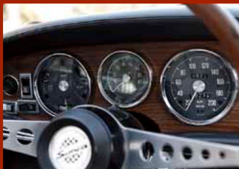
クロームで縁取られたイエーガーのメーター。メーターナセルもビニールレザーが縫いこまれて立体的になっており、上質感が漂う。精緻なアルミスポークのウッドリム・ステアリングはオリジナルだ。
