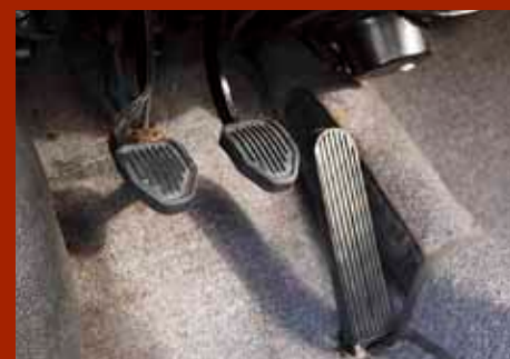
シムカ1000のパーツを流用していると思われるABCペダル。フロア・タイプのスロットルによりヒール・トゥも容易に行なえる。ブレーキとクラッチのペダルを支えるシャフト部はかなり頑強な作りになっている。
