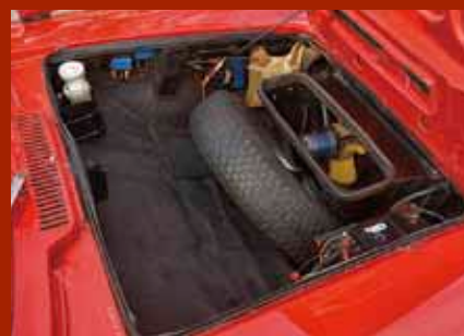
直下にフットボックスが組み合わさるため、思いのほか浅いフロント・スベース。スベア・タイヤと上抜きラジエーターユニットの取まり具合は見事なもの。
