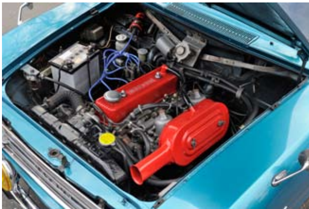
SPフェアレディや初代シルビアと同じR型OHV1595ccエンジン。ショートストロークの高回転型で、競技用にカムやバルブリフター、メタルガスケットなども用意されていた。タペットカバーは本来シルバー。
